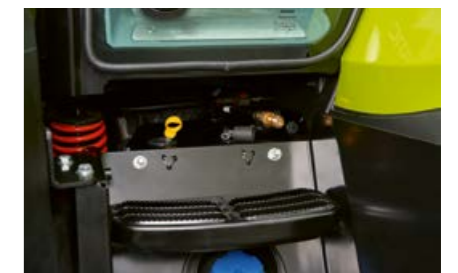
Vasemmalla, portaiden vieressä on paineilmaliitos.
