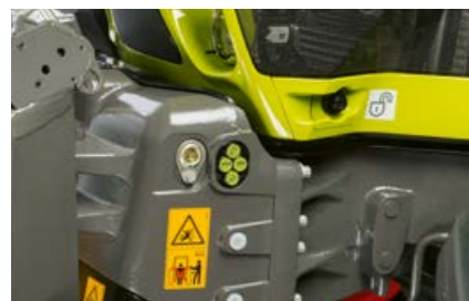
Etunostolaitteen ja yhden venttiilin ulkoinen hallinta (varustuksesta riippuen).
