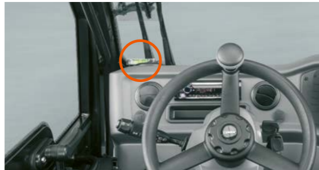
Wasserwaage in der Kabine
