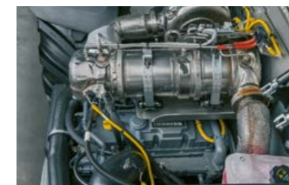
Der Dieselpartikelfilter regeneriert automatisch.
