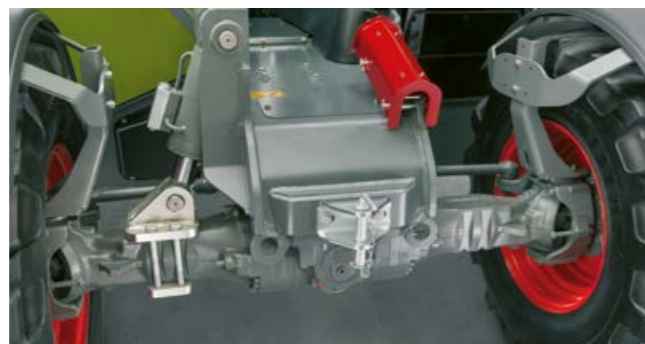
Mehr Sicherheit im Gelände durch hydraulischen Niveuausgleich
