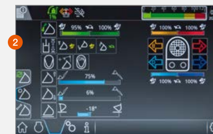
Begrensninger for løftehøyde og nedre dybde vises på den 9" store berøringsskjermen.
