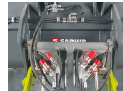
Foran på redskapskoblingen finnes trykløs retur og ekstra lekkoljetilkobling (644 / 537)
