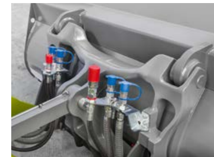
Alle hydraulikkuttak er lett tilgjengelige og beskyttet på redskapskoblingen. (956)
