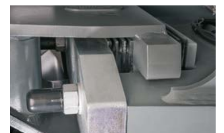
Gummidempere i det pendlende rammeleddet øker arbeidskomforten.
