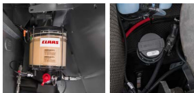
Oljepåfyllingsstussen for hydraulikkolje er plassert under panseret i et rent område. Oljenivået kan leses umiddelbart gjennom et godt synlig nivåglass.
