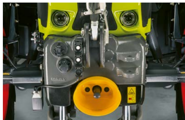
Prednji podizni uređaj ima priključke za upravljačku jedinicu i slobodni povratni vod.
