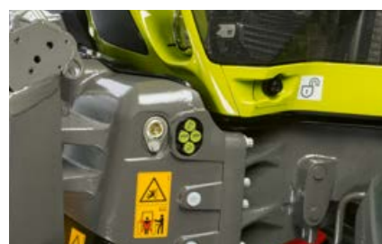
Vanjske kontrole za prednji podizni uređaj i upravljački uređaj (ovisno o opremi).
