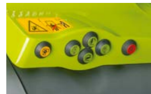
Vanjski upravljački elementi za stražnji podizni uređaj, priključno vratilo i upravljački uređaj po izboru (samo CEBIS).
