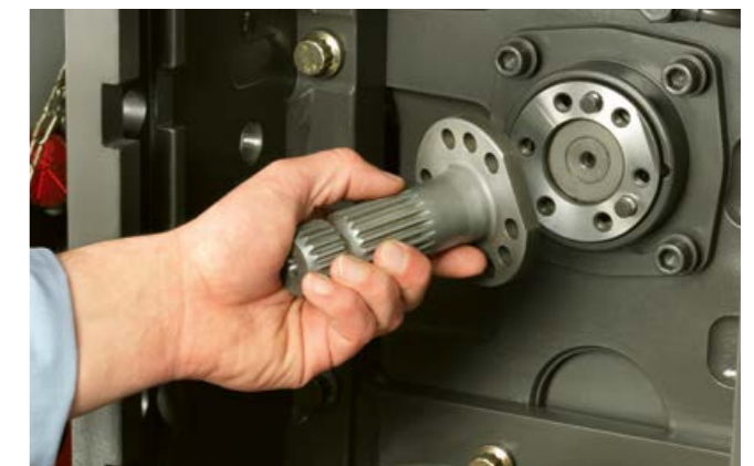
Jednostavna zamjena priključnog vratila.
