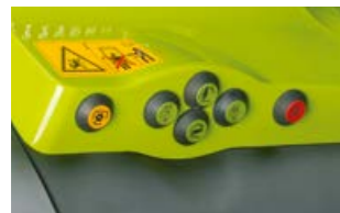
Zewnętrzne elementy obsługowe tylnego podnośnika, WOM i wybranego gniazda hydraulicznego (tylko CEBIS).
