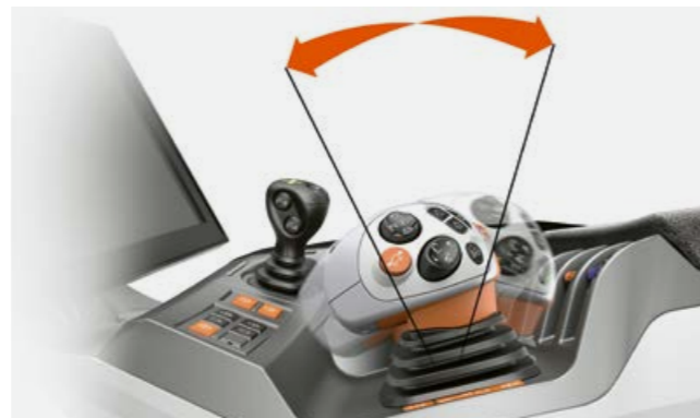
Obsługa progresywna dzięki technologii bezstopniowej przekładni CMATIC.
