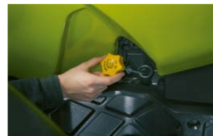
Sprawdzenie poziomu i uzupełnienie stanu oleju można wykonać przy opuszczonej masce silnika.
