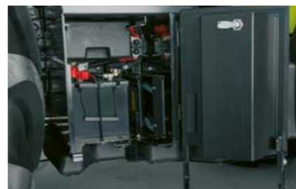
Bateria și un compartiment de depozitare a sculelor sunt amplasate la îndemână, la scara de acces din partea dreaptă.
