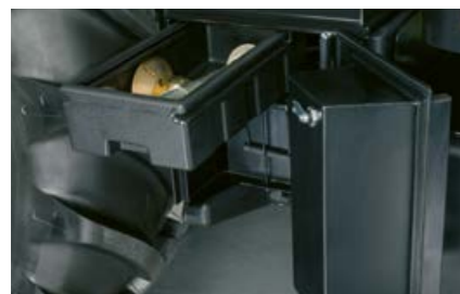
Bateria și un compartiment de depozitare a sculelor sunt amplasate la îndemână, la scara de acces din partea dreaptă.
