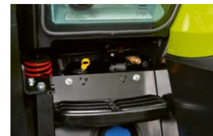
În partea stângă scării de acces veți găsi conexiunea pentru aerul comprimat.
