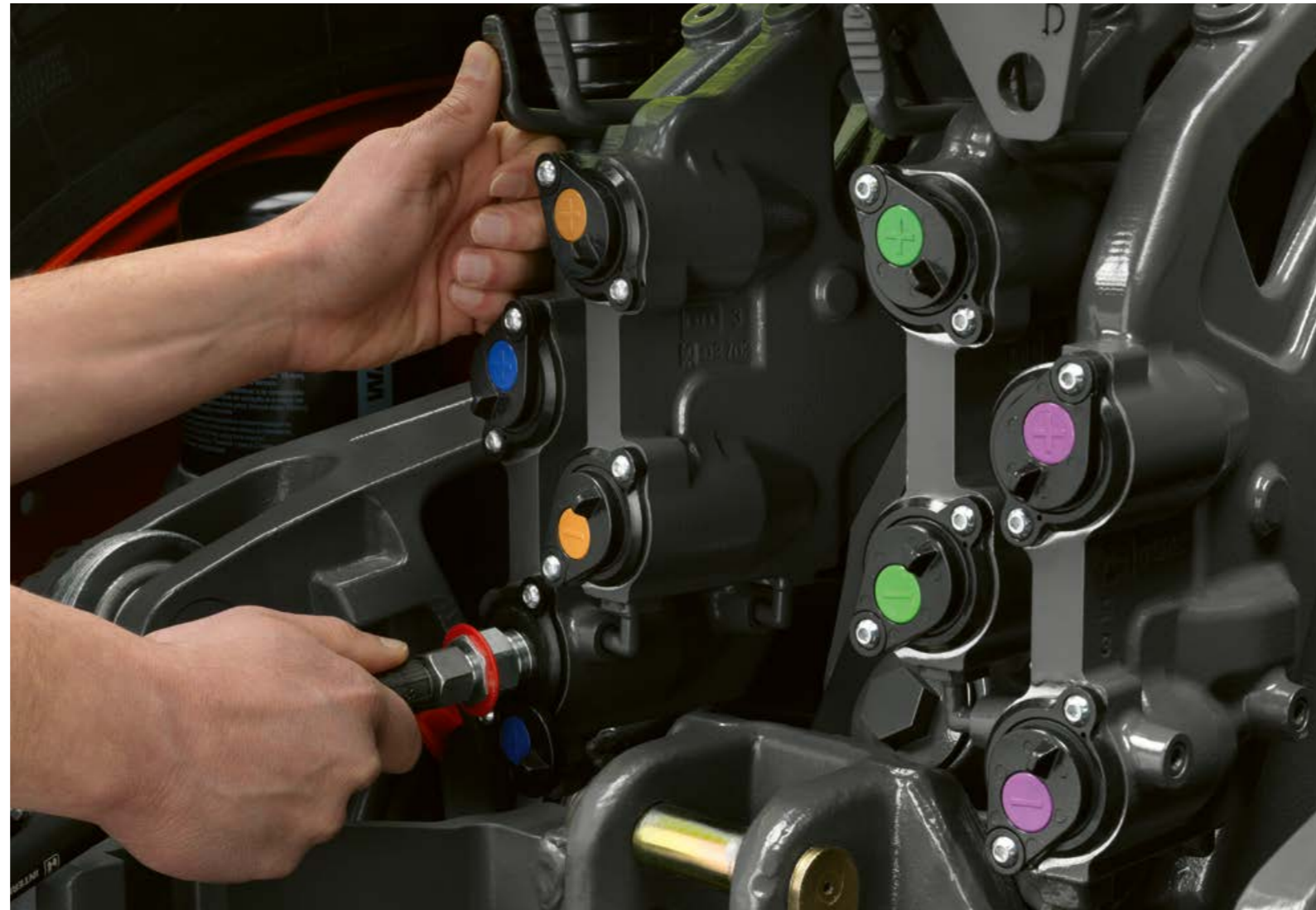
Tirantul față are conexiuni pentru o valvă hidraulică și un retur cu debit liber.
