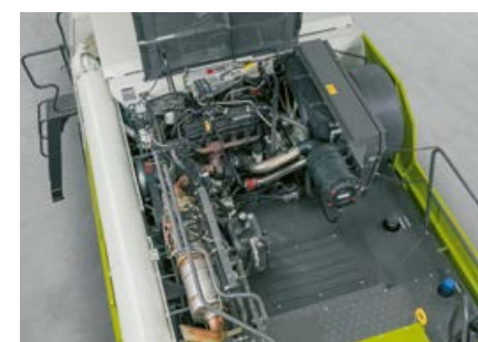
Двигатель Cummins с обработкой ОГ AdBlue (Stage V)
