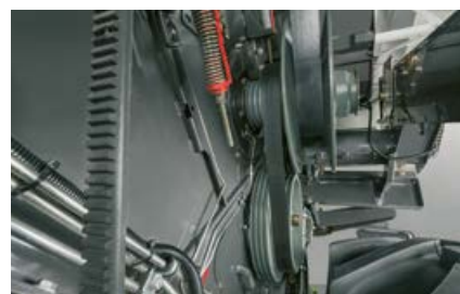
Привод молотильного барабана с двумя легко регулируемыми диапазонами скорости.
