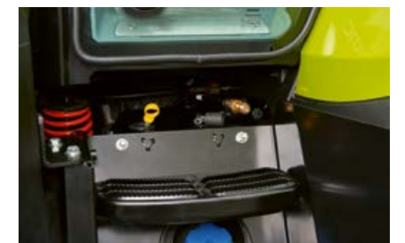
Links im Aufstieg befindet sich ein Druckluftanschluss.
