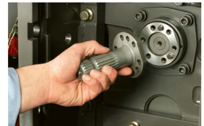
Einfacher Wechsel der Zapfwellenstummel
