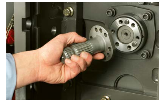
Embout de prise de force facilement interchangeable.
