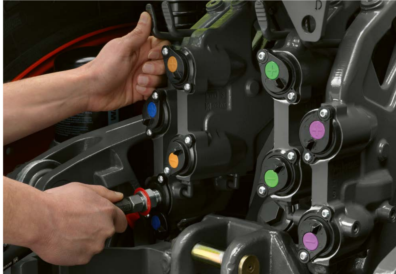
Les coupleurs sur le relevage avant permettent de brancher un distributeur et un retour libre.
