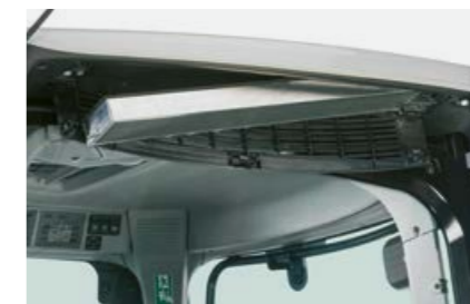
Accès facile au filtre à air de cabine intégré sous le toit.
