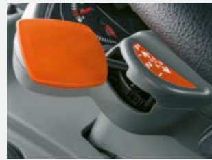
Palanca del cambio inversor REVERSHIFT disponible con freno electrónico de estacionamiento.
