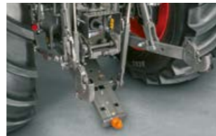
Alternativamente al soporte de enganche está disponible un enganche Pick-Up para remolque.
