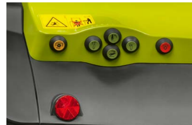
Control externo de la toma de fuerza trasera.
