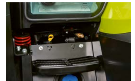
A la izquierda del acceso se encuentra una conexión de aire comprimido.
