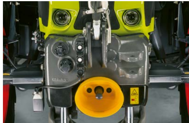
En el elevador delantero se encuentran conexiones para un distribuidor hidráulico y un retorno libre.
