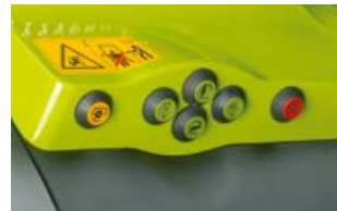
Controles externos para el elevador trasero, la toma de fuerza y un distribuidor hidráulico a elegir (solo CEBIS).
