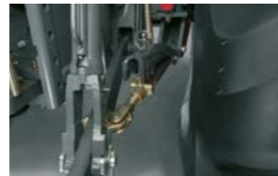
Estabilizadores automáticos de los brazos inferiores.
