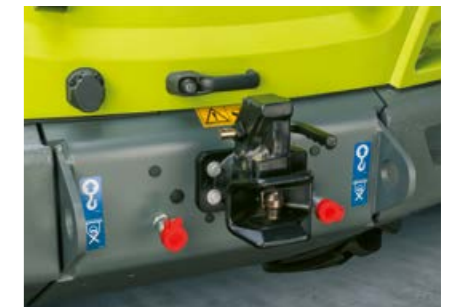
TORION 956 SINUS optional mit drucklosem hydraulischem Rücklauf am Heck
