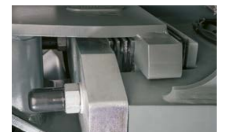
Gummidämpfer im Knickpendelgelenk erhöhen den Arbeitskomfort.
