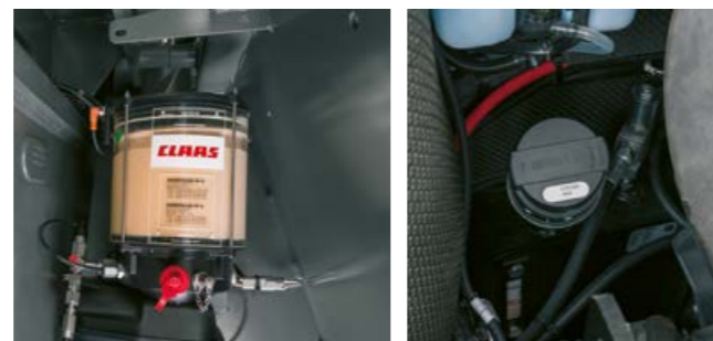
Der Öleinfüllstutzen für das Hydrauliköl ist unter der Motorhaube in einem sauberen Bereich untergebracht. Der Ölstand kann unmittelbar durch ein gut sichtbares Schauglas abgelesen werden.
