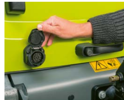
13-polige Steckdose am Heck für Anhängerbetrieb
