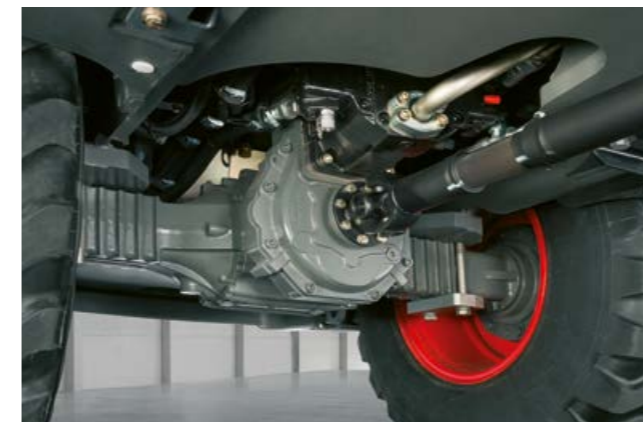
Hydrostatisches Getriebe mit selbsthemmender Bremswirkung
