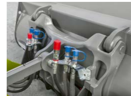
Alle Anschlüsse liegen gut erreichbar und geschützt am Werkzeugträger. (956)
