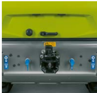
Aan de achterzijde zijn twee extra hydraulische snelkoppelingen aangebracht.
