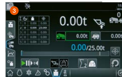
Het weegstelsysteem meet en documenteert nauwkeurig de dagelijks overgeslagen hoeveelheden.
