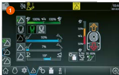
Met de hefhoogte- en dieptebegrenzing worden de ideale stand boven de bodem en uitkiephoogte opgeslagen.
