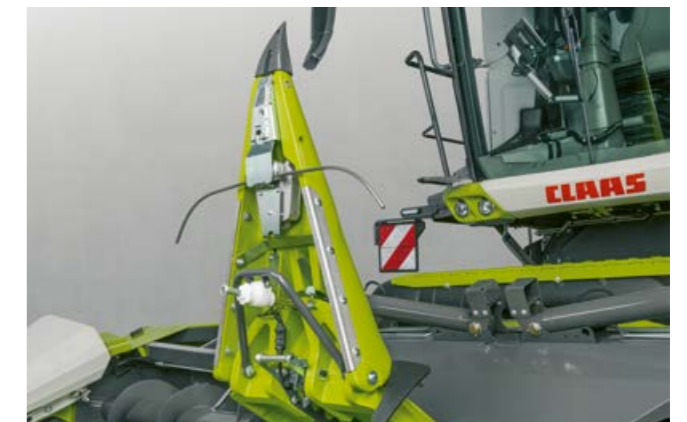
Svaki od dva nosača senzora skenira jedan red kukuruza.
