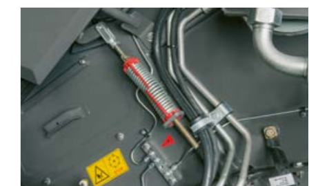
Sva mjesta za podmazivanje grupirana su u središnje trake za podmazivanje i jasno označena.
