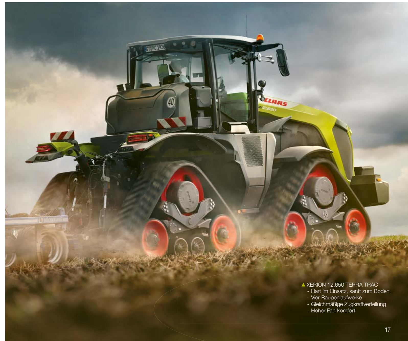
◀ Zwei Laufbandbreiten (914 mm oder 762 mm) garantieren maximale Bodenschonung. Mit den schmalen Laufbändern bleibt der XERION unter 3 m Breite.
