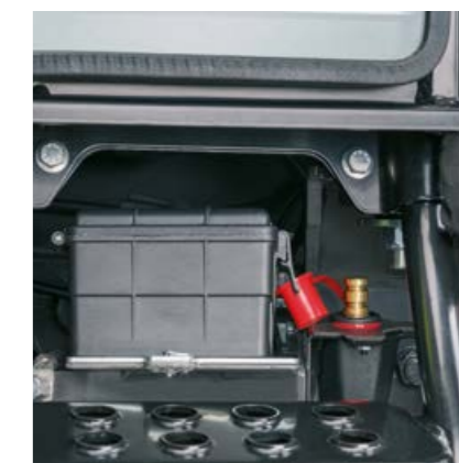
AXOS 200 încorporează o serie de soluții ingenioase concepute pentru a vă ușura munca de zi cu zi, cum ar fi bornele bateriei ușor accesibile în partea dreaptă a cabinei.
