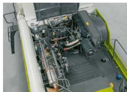
Motore Cummins con trattamento dei gas di scarico AdBlue (Stage V)
