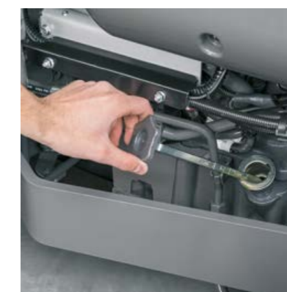
Nivelul uleiului poate fi verificat și completat cu capota închisă, pe partea dreaptă a modelului ELIOS 300.
