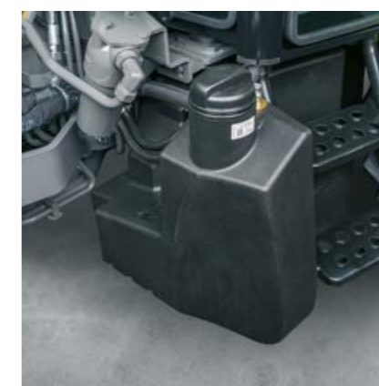
Rezervorul de carburant diesel de 105 l și rezervorul de uree de 10 l asigură o autonomie suficientă pentru zile lungi de lucru.
