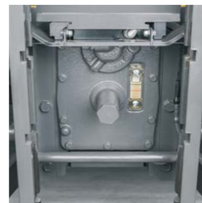
Puteți verifica nivelul uleiului de transmisie și al uleiului hidraulic printr-un vizor de lângă butucul prizei de putere spate.
