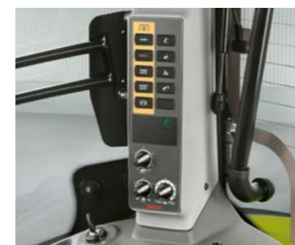
Sélection des régimes de prise de force et commandes du relevage arrière électronique installées sur le montant arrière droit de la cabine.
