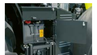
Accès optimal à la batterie à droite du marchepied d'accès à la cabine.
