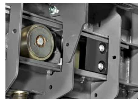
Die drehbaren Messer sind in zwei Positionen montierbar für den Einsatz in Stroh / Maisstroh oder in Heu / Silage.
