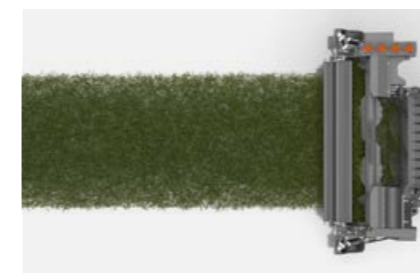
Podbieracz, PFS i dociskacz rolkowy dbają o optymalny przepływ materiału.
