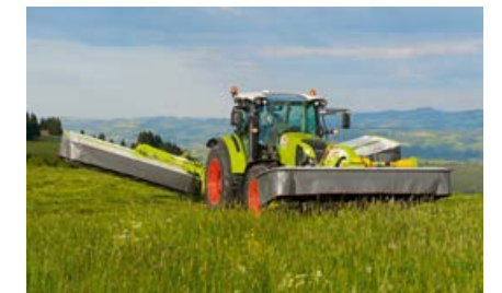
Zbog kompaktnog ovjesa na prednjem podiznom mehanizmu, kosilica ima veliki razmak od tla na uvratini.
