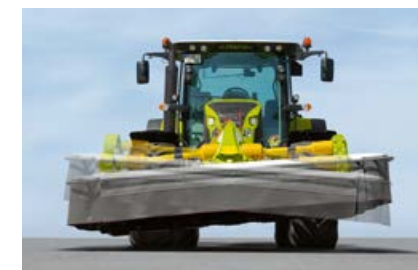
Suivi du sol perpendiculairement au sens d'avancement grâce à l'attelage oscillant librement.
