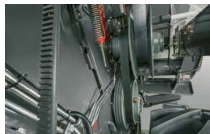
Entraînement de batteur à deux plages de régime faciles à sélectionner
