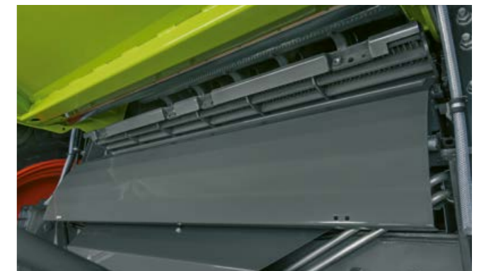
Retrait aisé du segment de contre-batteur à travers le bac à pierres
