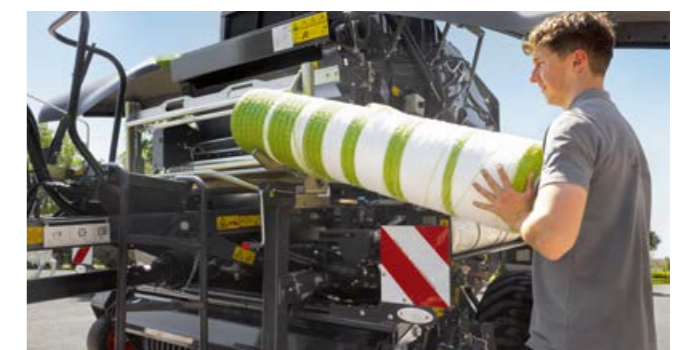
Die neue Netzbindung der VARIANT 500 Serie ist 25 cm tiefer, um die Netzrolle problemlos unter der Netzbremse reinigen zu können.
