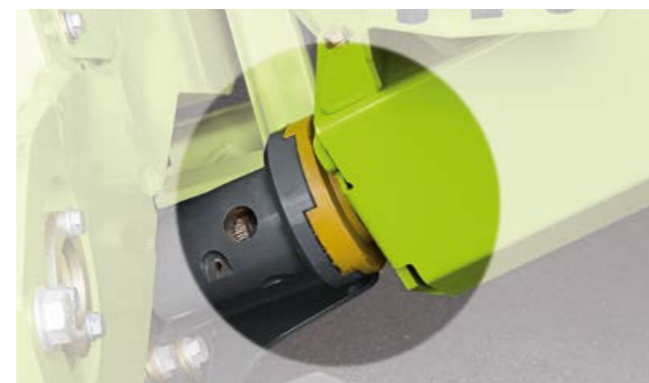
Traspaso de fuerza con acoplamiento rápido.
