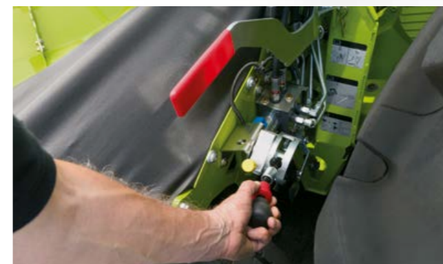
Adaptación en tres niveles del régimen de revoluciones de los cilindros de alimentación para un flujo óptimo.
