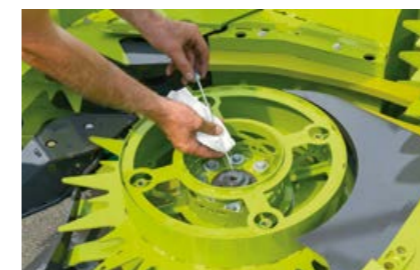
Varilla de medición de aceite para el control.
