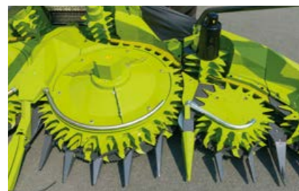
Transporte seguro de plantas en los canales de flujo.
