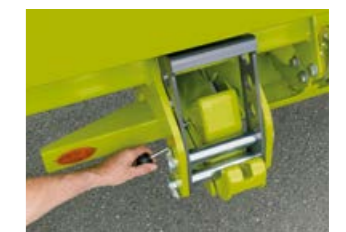
Tras empestillarlo, avance seguro con velocidades de hasta 40 km/h.
