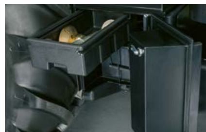
Jobbra a lépcsőnél, jól hozzáférhető helyen található az akkumulátor, és egy pormentes rekesz a szerszámoknak.
