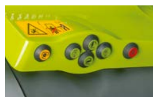
Külső kezelés a hátsó függesztőszerkezethez, TLT-hez és egy választható kihelyezett körhöz (csak a CEBIS-nél)
