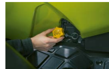
Olajsintellenőrzés és utántöltés zárt motorháztetőnél is lehetséges
