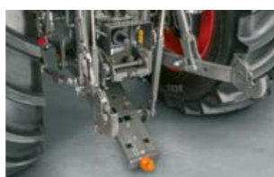
A vonóhorog alternatívájaként Hitch-hakenkuplung is rendelhető
