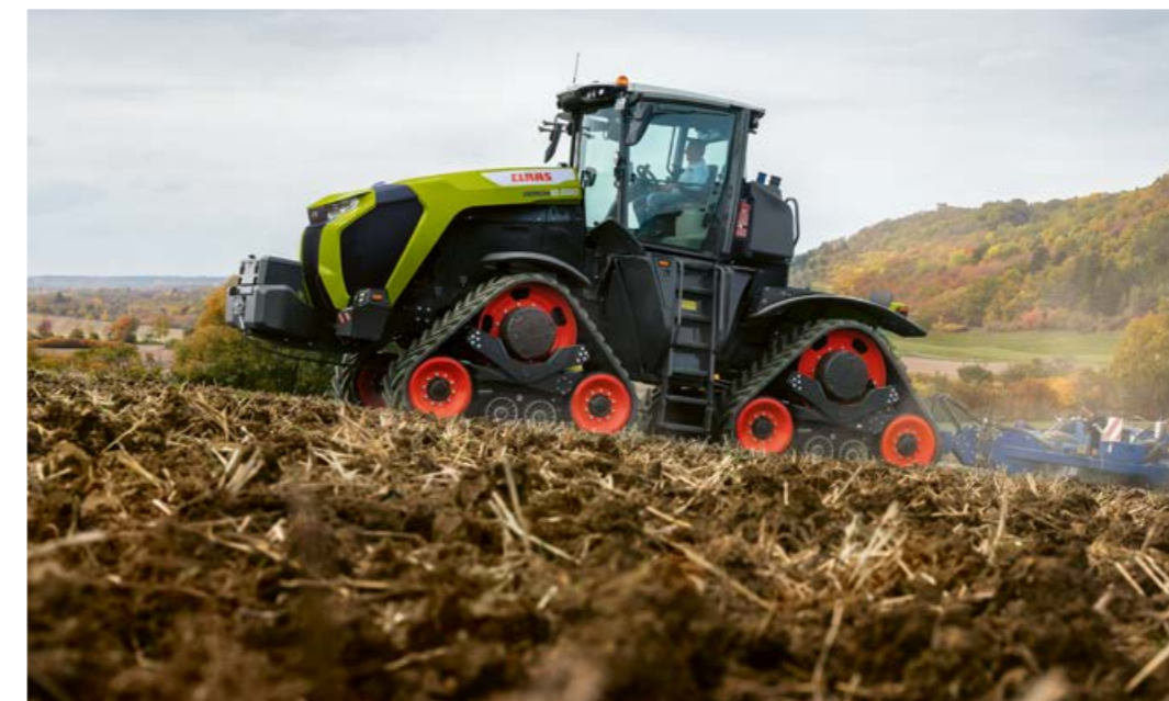
◀ L'amortissement des chenilles ainsi que la suspension du siège grand luxe et de la cabine en quatre points offrent au XERION une conduite très confortable.
