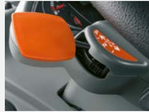
Inverseur sous charge REVERSHIFT avec frein de park électro-hydraulique.
