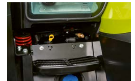
Une prise d'air comprimé est présente au-dessus du marchepied d'accès à la cabine côté gauche.
