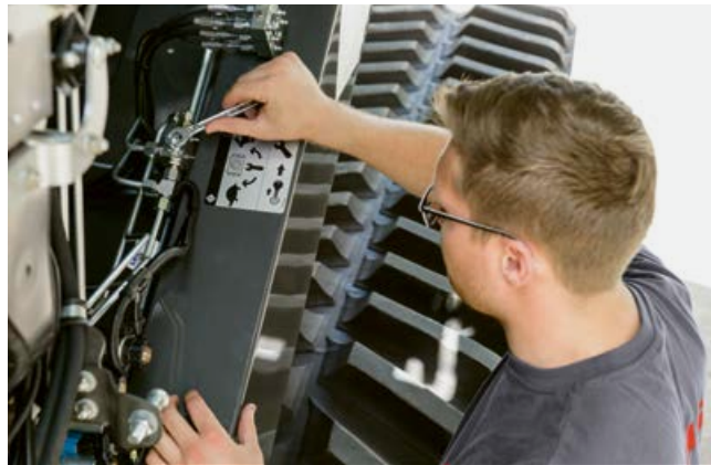
Broj okretaja reduktora bubnja vršilice mijenjate ručno hidrauličkim ventilom.
