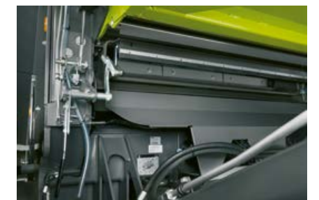
Veliko korito hvatača kamenja može se lako otvoriti i isprazniti.
