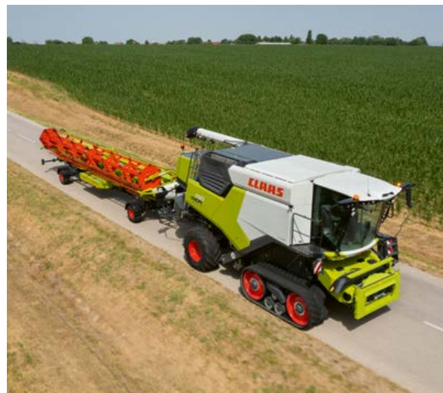
Sve gusjenice TERRA TRAC u potpunosti su sposobne za vožnju do 30 km/h i njima se može udobnije voziti od strojeva na kotačima.
