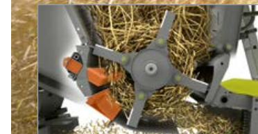
Kontra-nož i zakretni osnovni element u sjeckalici SPECIAL CUT (Posebno rezanje)
