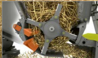
Contracuchilla y elemento giratorio de fondo en el picador SPECIAL CUT
