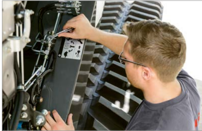
Broj okretaja reduktora bubnja vršilice mijenjate ručno hidrauličkim ventilom.
