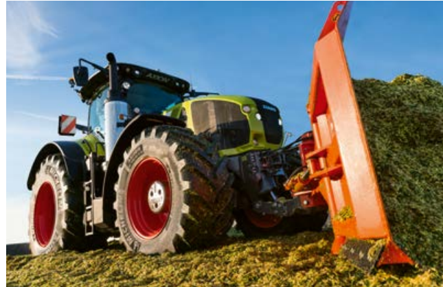
En combinación con el elevador delantero están disponibles hasta dos distribuidores hidráulicos de doble efecto y un retorno libre en la parte delantera. Ideal para una tolva o una plancha compactadora montada en la parte delantera.
