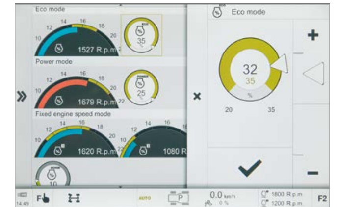
Ajuste del régimen reducido del motor para "Eco" y "Power", así como para la memoria del régimen de revoluciones.
