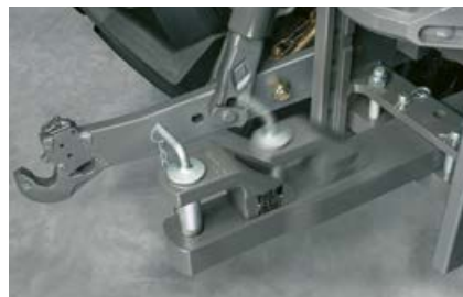
Las variantes con garfio de tracción ofrecen varias posiciones. La posición sacada ofrece una mejor maniobrabilidad.
