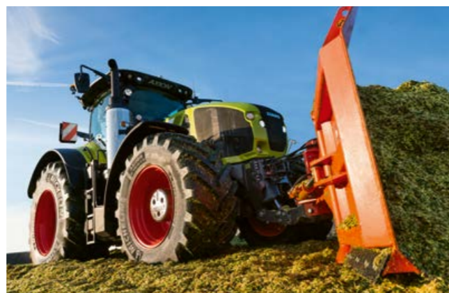
In abbinamento con il sollevatore anteriore sono disponibili fino a due innesti a doppio effetto e una linea di ritorno libera sulla parte anteriore. Soluzione ideale per attrezzature montate frontalmente.
