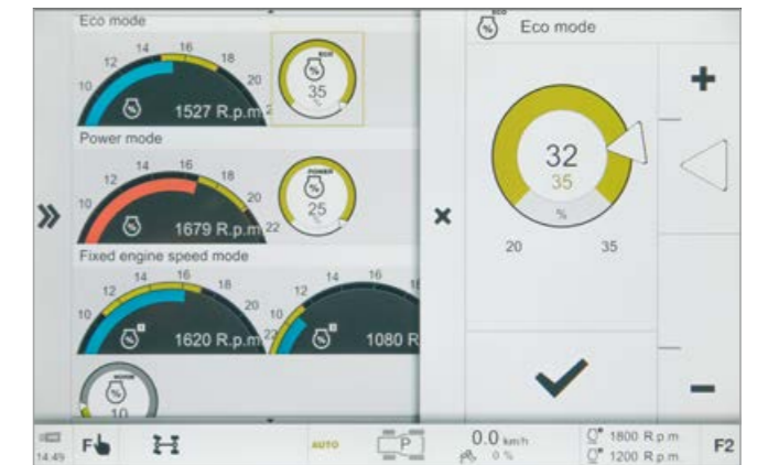
Impostazione del carico del motore per i valori «Eco» e «Power» e della memoria regime motore.
