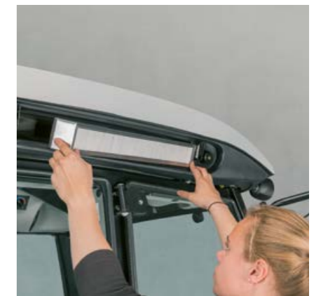
O filtro de ar da cabina é facilmente acessível do exterior para limpeza e facilita a refrigeração do ambiente na cabina.
