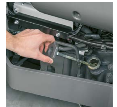
O controlo do nível de óleo e o reabastecimento é realizado com o capot fechado do lado direito do ELIOS 200.
