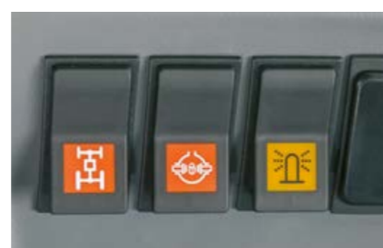
Conexão elétrica da tração às quatro rodas e do bloqueio do diferencial: através do corte de energia de segurança dependente da velocidade, evitam-se utilizações incorretas.
