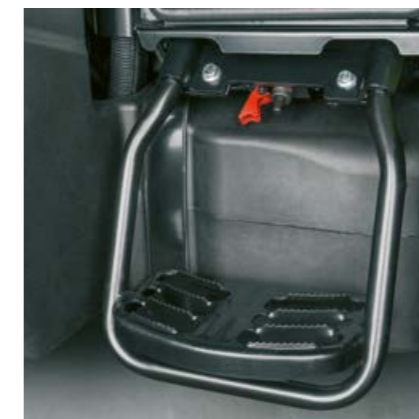
O disjuntor da bateria encontra-se à mão, na entrada esquerda. (exceto o ELIOS 210)
