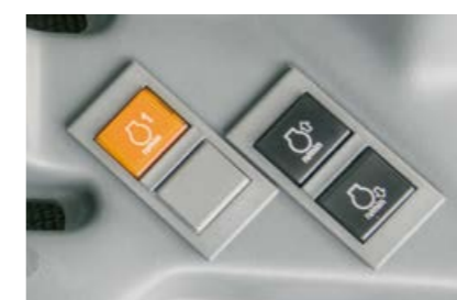
Os trabalhos com tomada de força são especialmente fáceis de concretizar – graças à memória de rotações do motor de série.
