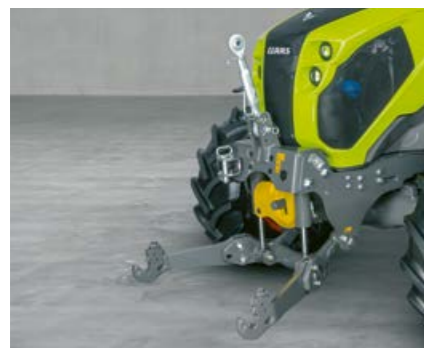
O elevador frontal opcional, com 3,2 t de capacidade de elevação e a tomada de força frontal alargam o espectro de ação do ELIOS.
