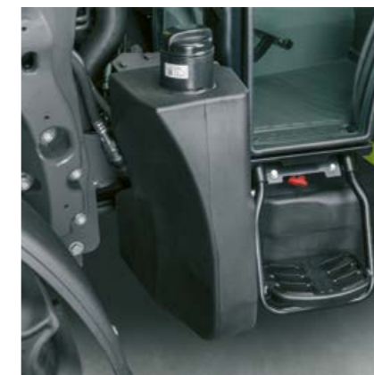
O depósito de diesel de 95 l e o depósito de ureia de 10 l permitem uma autonomia suficiente, mesmo em dias de trabalho intenso.
