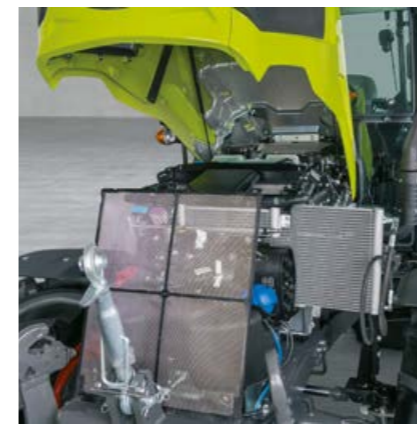
En deux temps, trois mouvements, le radiateur s'escamote et le tamis du radiateur se retire pour le contrôle et le nettoyage.
