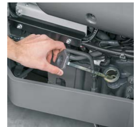
Le contrôle du niveau d'huile et l'appoint d'huile peuvent s'effectuer capot fermé sur le côté droit de l'ELIOS 300.
