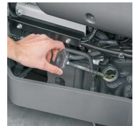
Provjera razine ulja i ponovno punjenje obavlja se sa zatvorenim poklopcem motora na desnoj strani traktora ELIOS 300.
