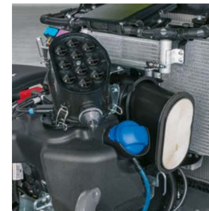
Filter za zrak PowerCore® lako je dostupan sprijeda ispod poklopca motora i smanjuje intervale čišćenja.
