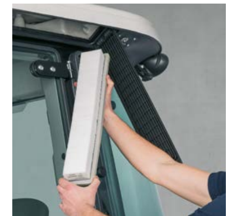
Filter zraka u kabini lako je dostupan izvana radi čišćenja i osigurava svježiu klimu u kabini u svakom trenutku.
