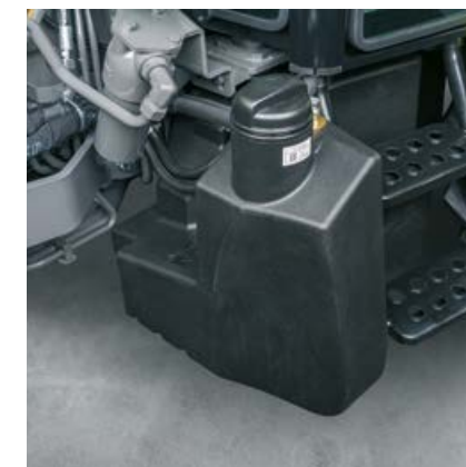
Spremnik dizela od 105 l i spremnik uree od 10 l omogućuju dovoljan domet čak i tijekom dugih napornih radnih dana.
