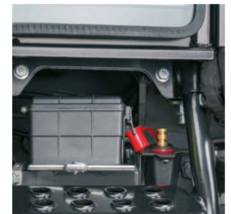
ELIOS 300 vam olakšava svakodnevni život mnogim inteligentnim rješenjima kao što su pomaknuti polovi baterije na desnoj strani kabine.
