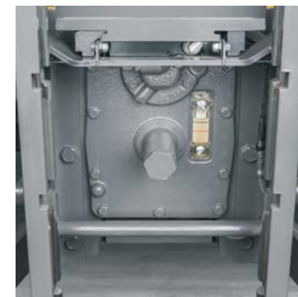
Razinu ulja u mjenjaču i hidrauličkom sustavu možete provjeriti kroz kontrolno staklo pored okrajka kardanskog vratila.
