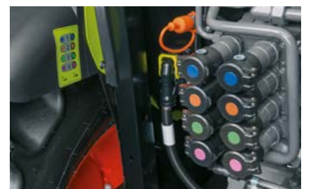
Priključci na stražnjem dijelu lako se prepoznaju po oznakama u boji i naljepnicama postavljenim u blizini.
