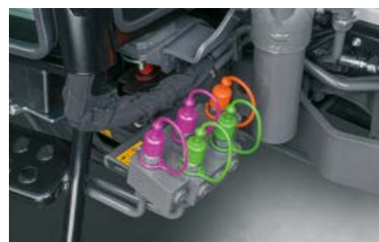
Sprijeđa su dostupna do četiri hidraulička priključka i slobodan povrat.
