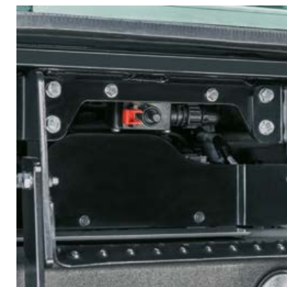
Prekidač za isključivanje akumulatora je prikladno smješten na lijevom ulazu.
