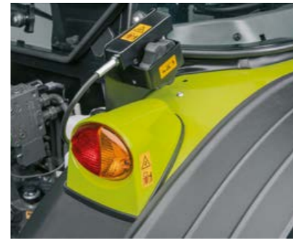
Le relevage arrière mécanique peut être commandé depuis l'arrière du tracteur pour l'attelage des outils.
