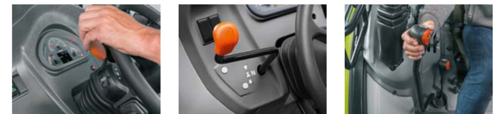
Situé à portée de main à gauche du volant, l'inverseur est commandé au choix de façon mécanique ou électro-hydraulique avec le REVERSHIFT.
