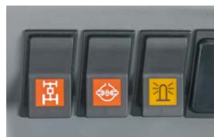
Engagement ou désengagement électro-hydraulique des quatre roues motrices et du blocage de différentiel : le désengagement de sécurité en fonction de la vitesse permet d'éviter des erreurs de commande.
