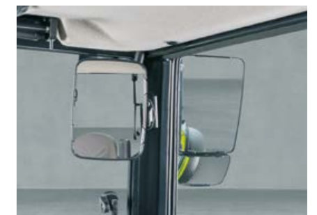
Un rétroviseur grand angle est disponible en plus du large rétroviseur pour une sécurité accrue sur la route.
