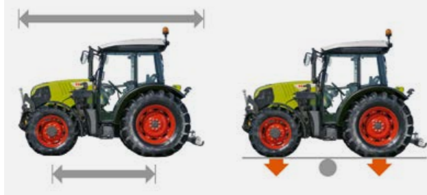
Empattement long et répartition optimale des masses
