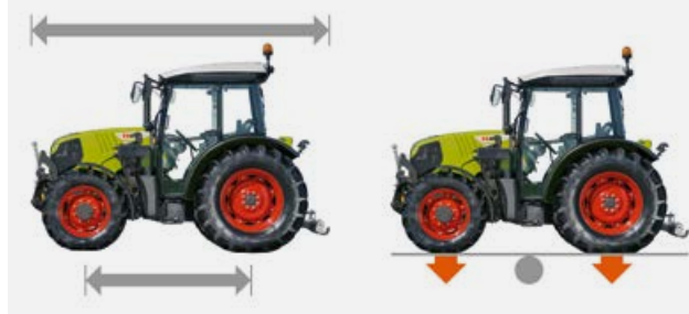
Empattement long et répartition optimale des masses
