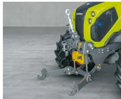
Le relevage avant de 3,2 t en option et la prise de force avant assurent la polyvalence de l'ELIOS.
