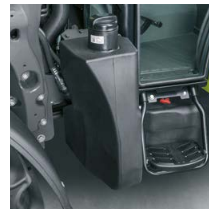
Le réservoir de carburant de 95 l et le réservoir d'urée de 10 l offrent suffisamment d'autonomie même pour les longues journées de travail.
