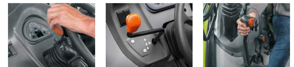
Situé à portée de main à gauche du volant, l'inverseur est commandé au choix de façon mécanique ou électro-hydraulique avec le REVERSHIFT.
