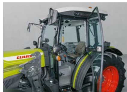
L'accès au poste de conduite est facile même dans des bâtiments exigus. Les larges portes s'ouvrent en grand sans trop dépasser de la machine.
