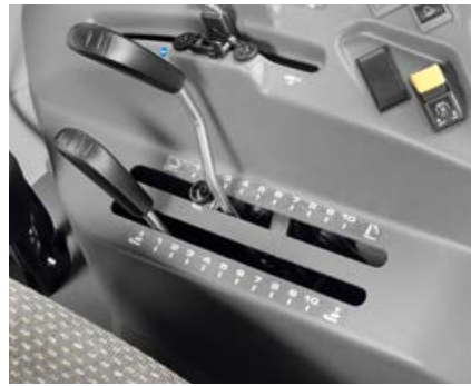
La commande mécanique du relevage arrière est placée de façon ergonomique à droite du siège conducteur.
