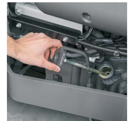
Le contrôle du niveau d'huile et l'appoint d'huile peuvent s'effectuer capot fermé sur le côté droit de l'ELIOS 200.
