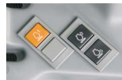
Les travaux à la prise de force sont aisés avec l'ELIOS, notamment grâce à la mémoire moteur de série.
