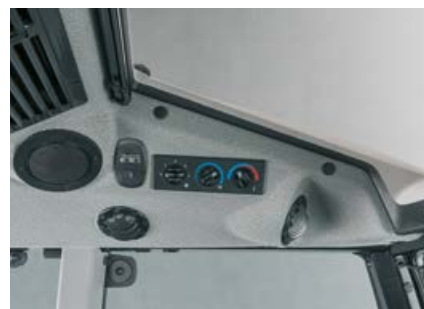
Le système de chauffage et de ventilation intègre un ventilateur à quatre vitesses et de nombreuses buses de ventilation réglables. Une climatisation réglable est également disponible.
