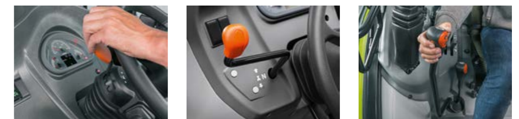
El cambio inversor siempre está a mano a la izquierda del volante, opcionalmente electrónico con REVERSHIFT o mecánico.
