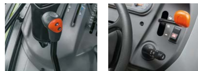
Se ofrece opcionalmente un doblador mecánico a la derecha del volante o la conmutación de carga TWINSHIFT que se maneja con la palanca de cambio de marchas.
