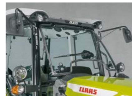
Für eine natürliche Belüftung kann die Frontscheibe aufgestellt werden.
