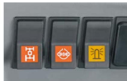
Elektrische Schaltung von Allrad- und Differenzialsperre: Durch die geschwindigkeitsabhängige Sicherheitsabschaltung werden Fehlbedienungen vermieden.
