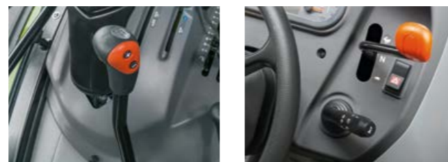
Es gibt wahlweise eine mechanische Untersetzung rechts neben dem Lenkrad oder die komfortable TWINSHIFT Zweifachlastschaltung, die am Gangschalthebel bedient wird.
