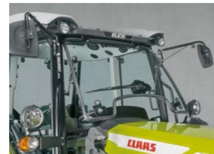
Für eine natürliche Belüftung kann die Frontscheibe aufgestellt werden.
