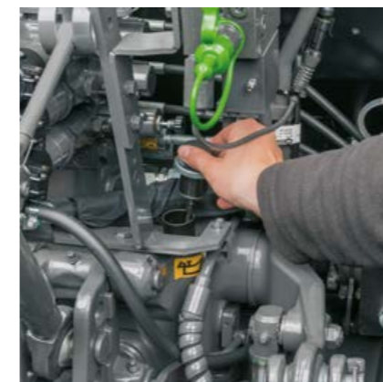
Den Ölstand von Getriebe und Hydraulik kontrollieren Sie einfach am Heck.
