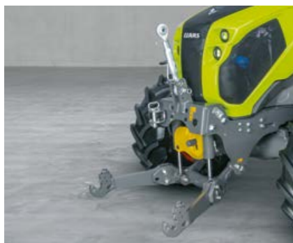
Il sollevatore anteriore, a richiesta, con una capacità di sollevamento di 3,2 t e la presa di forza frontale ampliano la gamma delle applicazioni dell'ELIOS.
