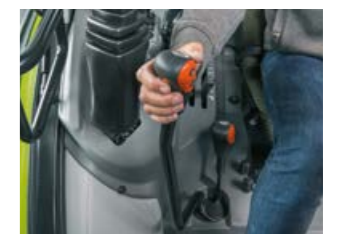
Con inversore REVERSHIFT: comando della frizione elettronica mediante pulsante sulla leva del cambio.
