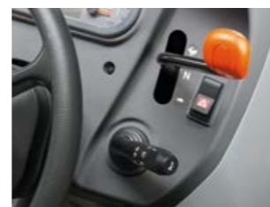
A scelta, è disponibile un doppiatore meccanico posizionato a destra vicino al volante o un comodo doppiatore multiplo sotto carico TWINSHIFT, azionabile con la leva del cambio.
