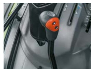
A scelta, è disponibile un doppiatore meccanico posizionato a destra vicino al volante o un comodo doppiatore multiplo sotto carico TWINSHIFT, azionabile con la leva del cambio.
