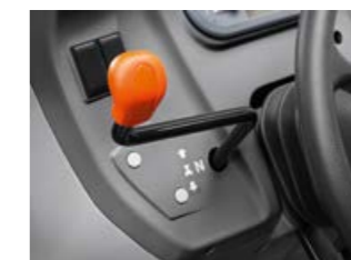
L'inversore meccanico o l'inversore elettro-idraulico REVERSHIFT sono posizionati comodamente a sinistra del volante.
