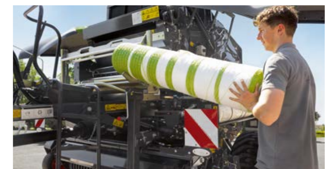
La nuova legatura a rete della serie VARIANT 500 è posizionata più in basso di 25 cm per poter pulire facilmente il rotolo di rete sotto il freno della rete.
