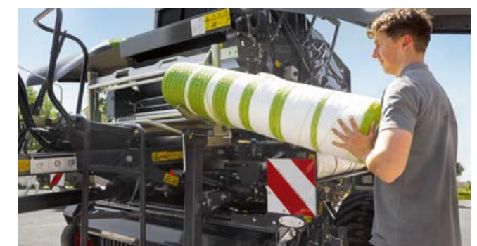
Nowy system owijania siatką w prasach VARIANT z serii 500 pracuje o 25 cm niżej, co umożliwia bezproblemowe czyszczenie rolki siatki pod hamulcem siatki.
