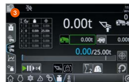
Kaalumissüsteem mõõdab ja dokumenteerib täpse päevas teiseldataud koguse.
