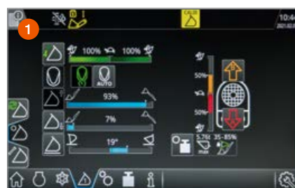
Tõste- ja langetuskõrguse piirang salvestab ideaalse maapinnalähedase asendi ning ideaalse väljakallutuskõrguse.
