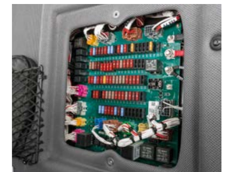
Elektronika on koondatud kokku ja sellele pääseb kergesti ligi.
