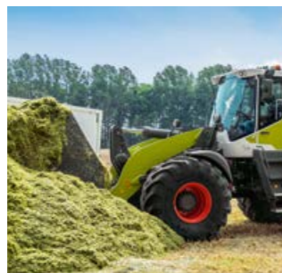
Vähendatud väljakallutuskiirus kaitseb tõstemasti komponente.
