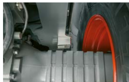
Pentru a permite utilizarea unor anvelope deosebit de mari în aplicațiile agricole, traiectoria de oscilație a punții spate poate fi limitată.
