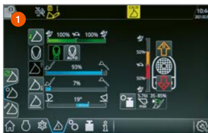
Limitele privind înălțimea de ridicare și coborâre rețin nivelul ideal de lucru în apropierea solului și înălțimea de descărcare.
