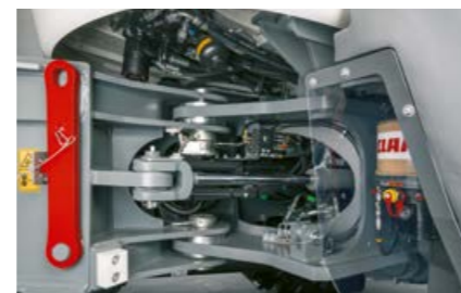
Articulație pivotantă cu unghi de articulare de 40° transformă TORION într-un model agil și ușor de manevrat.
