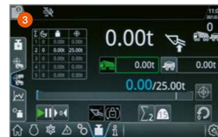
Sistemul de cântărire măsoară și documentează cu precizie volumele zilnice manipulate.
