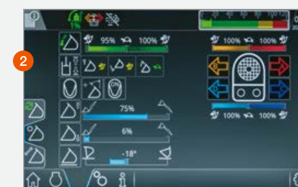
Ustawienia wysokości podnoszenia i opuszczania są wyświetlane na 9-calowym ekranie dotykowym.
