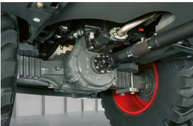
Przekładnia hydrostatyczna z samoczynnym hamowaniem
