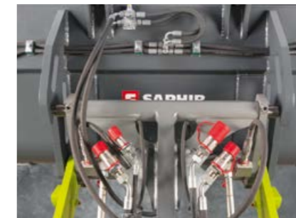
Ees on tööriista kanduriga ühendatud survevaba tagasivool ja täiendav lekkeõlitoru (644 ja 537).
