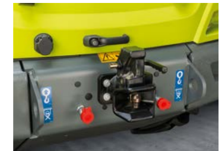
Mudeli TORION 956 SINUS lisavarustusse kuulub tagumine survevaba hüdrauliline tagasivool.
