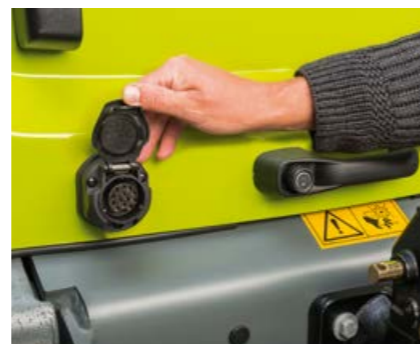
Taga 13 kontaktiga pistikupesa haagise kasutamiseks.
