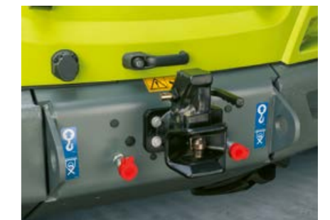
TORION 956 SINUS poate fi echipat opțional cu o linie hidraulică de retur cu debit liber pentru partea spate
