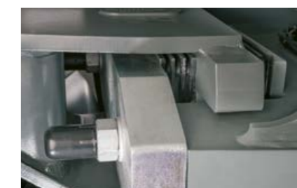
Amortizoarele din cauciuc integrate în articulația pivotantă sporesc confortul operatorului.
