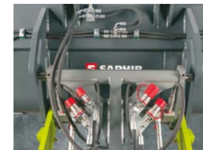
Retur cu debit liber pentru partea frontală și o linie suplimentară de preaplin de ulei cu conexiune la cadrul pentru implemente (644 / 537)
